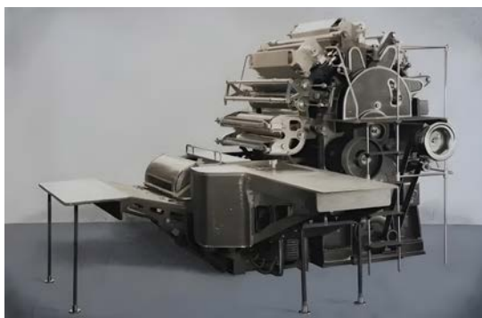
135. ábra: Ganz HAEF5 metszetnyomógép, amellyel az 1930-as évektől a bankjegyek nyomtatása történt. Forrás: Pénzjegynyomda Zrt.
